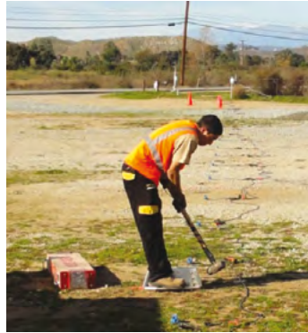
Piastra in alluminio con martello come sorgente sismica dell'onda di taglio.
