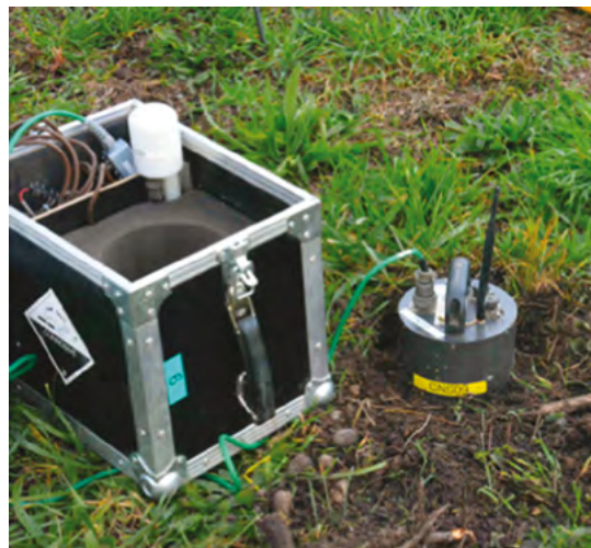
FIGURA 10 Esempio di sismometro 3D a 30 s utilizzato per misurazioni passive (a destra: sensore 3D, livellato, orientato, collegato alla sua batteria e dotato di un'antenna per la connessione wireless col registratore di dati centrale; a sinistra: GPS per la sincronizzazione, collocato nella custodia).
