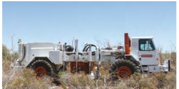
Vibratore sismico della Industrial Vehicles International (per gentile concessione dell'Università del Texas ad Austin).
