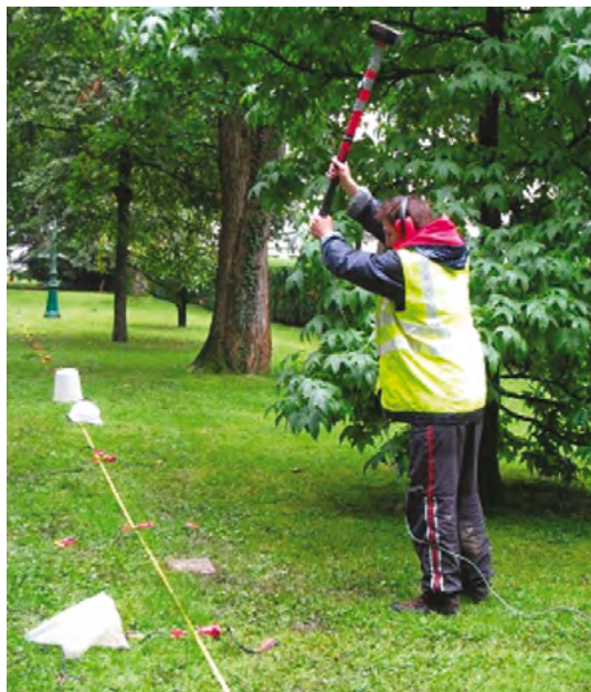
FIGURA 4 Esempio di sorgenti a impatto verticale. A sinistra: mazza da 5 kg; a destra: caduta di un peso.
